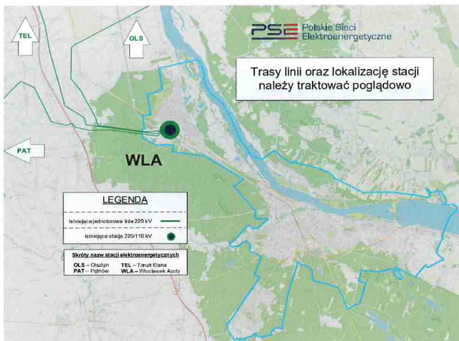
Rys. 13 Schemat sieci należących do PSE S.A na terenie miasta Włocławek Źródło: PSE S.A.
